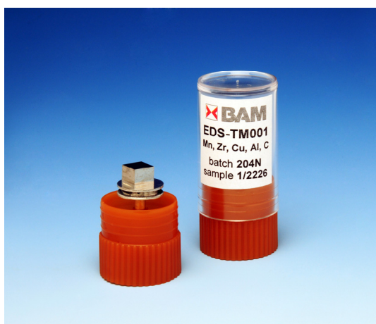
FIG. 1. Test material EDS-TM001 [4].
