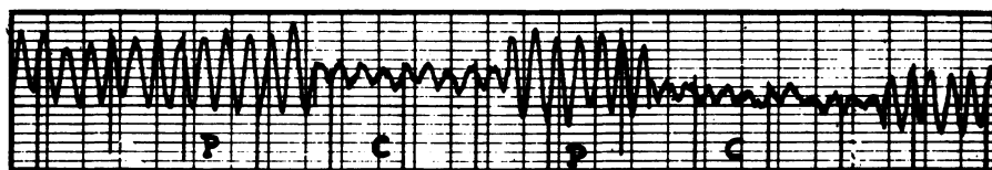
FIG. 11. Enregistrement montrant la polarisation circulaire d'une source persistante. P = parallèle; C = croisée.
